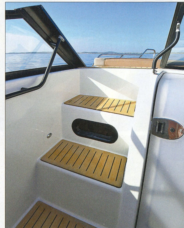
L'accès au pont avant se fait par un passage sur bâbord constitué de trois marches et de solides mains courantes. Le pare-brise s'ouvre à ce niveau.
