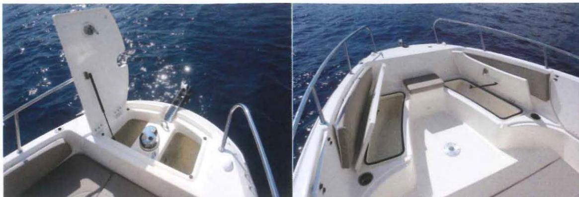
La baille à mouillage dispose d'une grande ouverture assistée par vérin.
