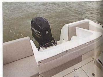
La partie centrale de la banquette se bascule afin de relever le moteur.
